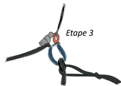
Les 4 étapes de connexion de la sellette à la voile
