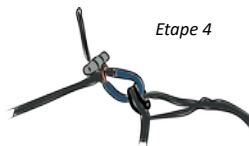
Les 4 étapes de connexion de la sellette à la voile
